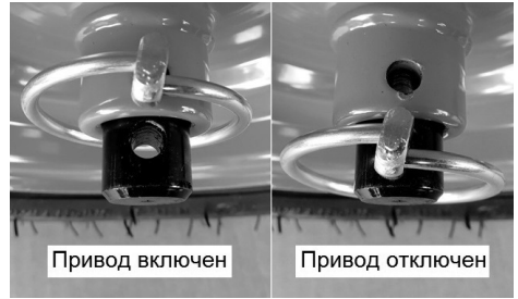
Рис. 35 Перестановка шплинта на левом колесе
