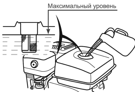
Рис. 28 Максимальный уровень топлива в топливном баке
