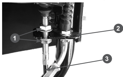
Рис. 11 Крепление оболочки троса включения хода
