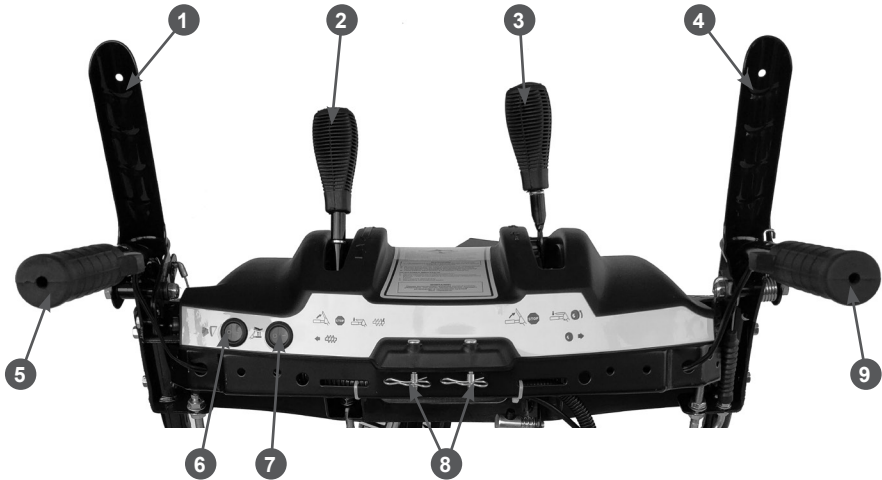
Рис. 2 Панель управления (вид со стороны оператора)
