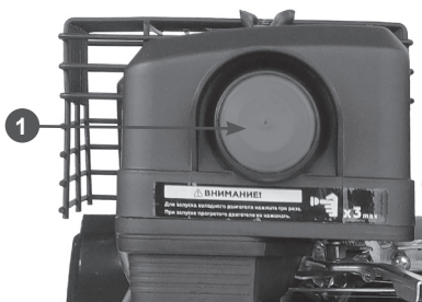
Рис. 34 Расположение ручного топливного насоса
