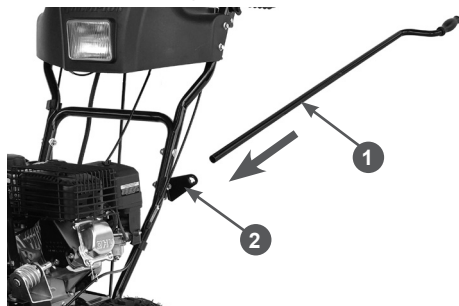
Рис. 24 Установка рычага управления поворотом жёлоба
